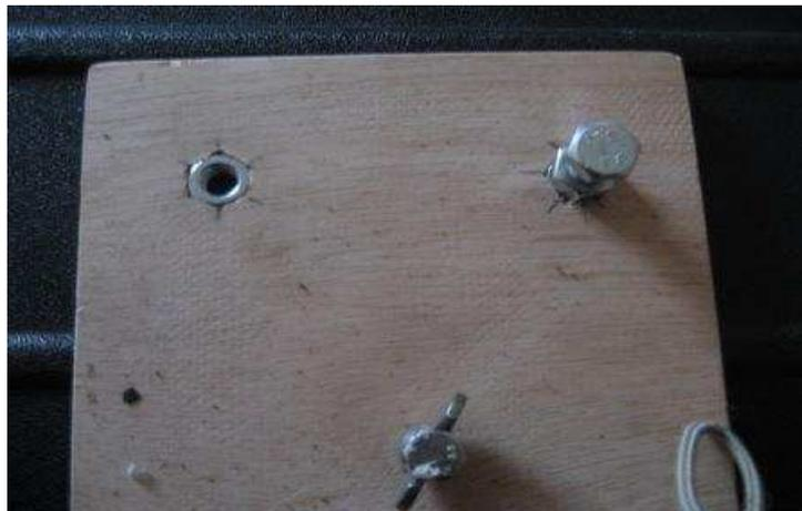
(Trou +écrou écroui, boulon+ écrou de réglage fin)
