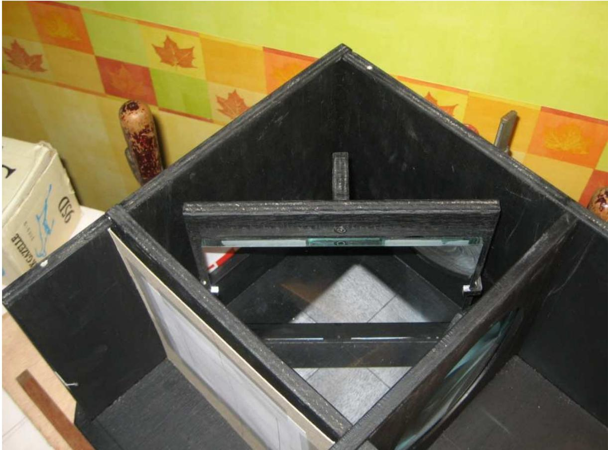
(vue du miroir posé avec son équerre arrière permettant d'être bien perpendiculaire à l'embase .On peut voir l'intersection des droites D1 et D2 et le point T , sur cette photo la règle R a été retirée après fixation définitive du porte miroir)
