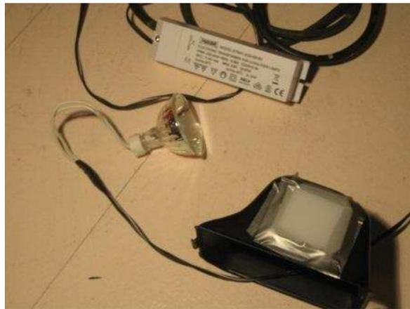
(Lampe 20watts, transfo, cache avec diffuseur)
