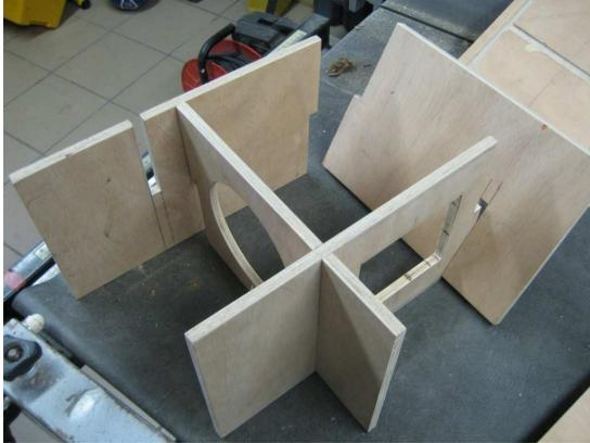
(l'assemblage des pièces du boitier)
